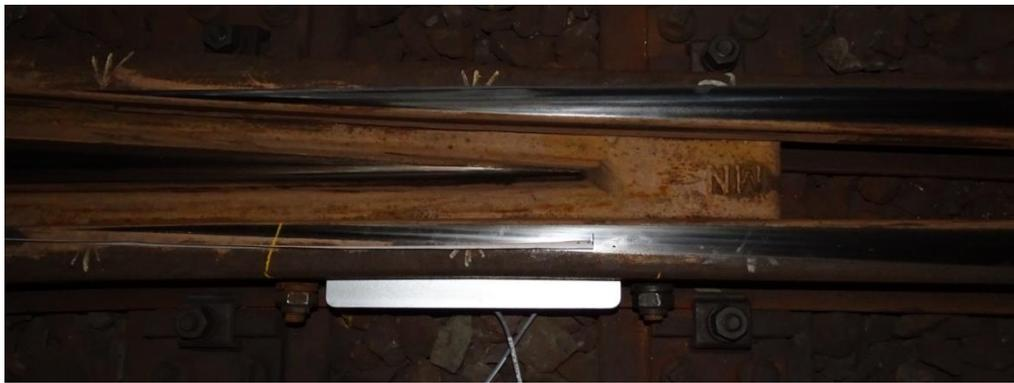
Abbildung 69 Sensorposition am Herzstück - Draufsicht
