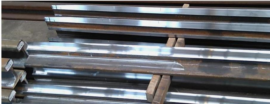
Abbildung 10 Geschliffene Zungenprofile
