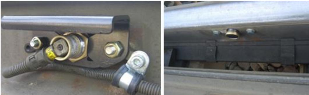
Abbildung 43 Zungensensor: Außenansicht (li) und Innenansicht (re) [17]
