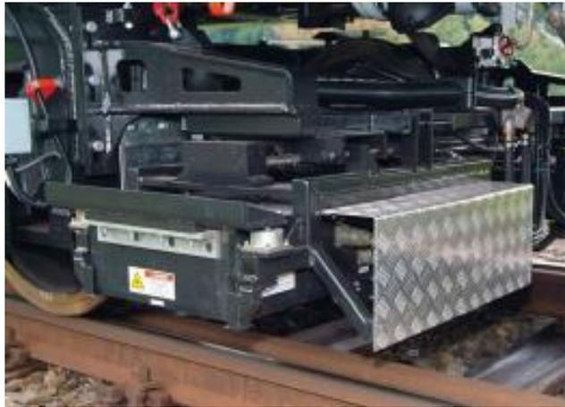
Abbildung 46 Schienenprofil-Messsystem [30]
