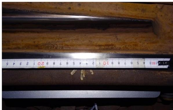
Abbildung 70 Sensorposition am Herzstück - Vermessung Draufsicht
