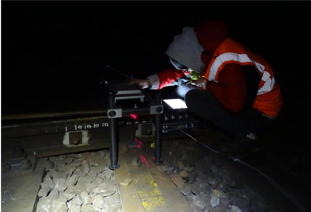
Abbildung 76 Profilvermessung des Herzstückes mit CALIBRI
