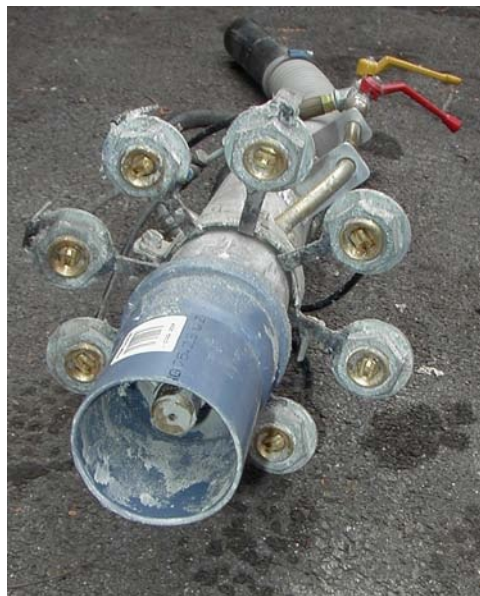
Abb. 15 Neuentwickelter Spritzkopf mit kombinierter Innen- und Außenbefeuchtung für getrennt regelbare Durchsatzmengen (vorderes Absperrventil = Mitteldüse, hinteres Absperrventil = Ringdüsen)
