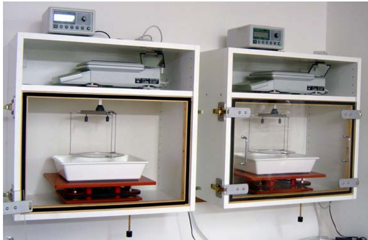
Abb. 48 Messapparatur zur Bestimmung des Wasseraufnahmekoeffizienten
