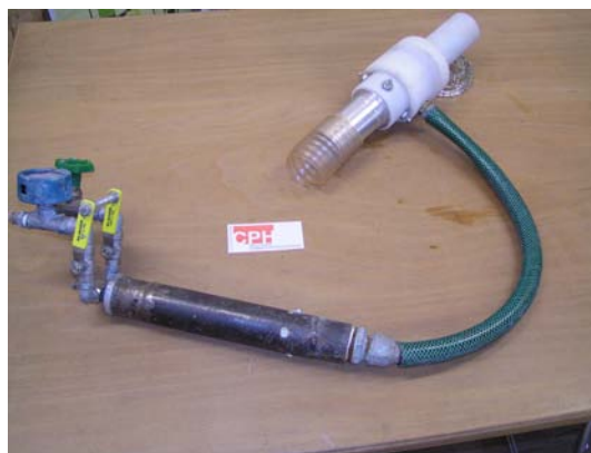
Abb. 13 Schaumerzeugungseinheit (vorne) und umgebaute Spritzbetondüse
