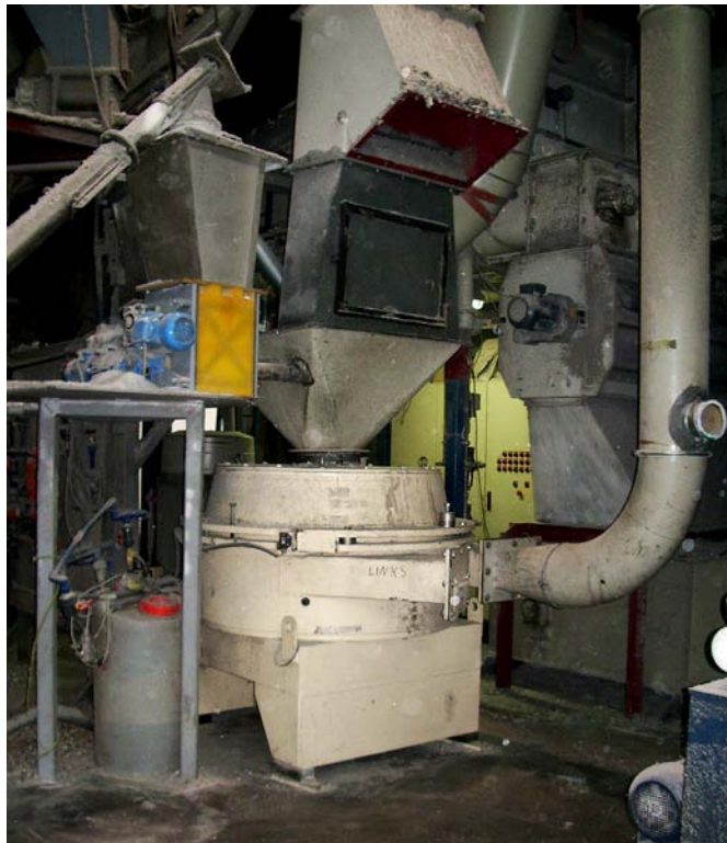
Abb. 1 Mühle in der Produktionsanlage für Zellosedämmstoff mit Pulver-Zudosierer für Brand- und Insektenschutzmittel (links), Einfüllstrecke (mitte) und Austragvorrichtung (rechts)
