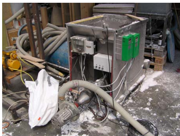
Abb. 8 Vorversuch der Fördermaschine mit Saugventilator (links vorne) anstelle der Zellradschleuse
