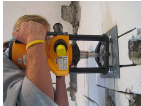
Abb. 42 Haftzugmessung mit der Freundl F20D Easy2000
