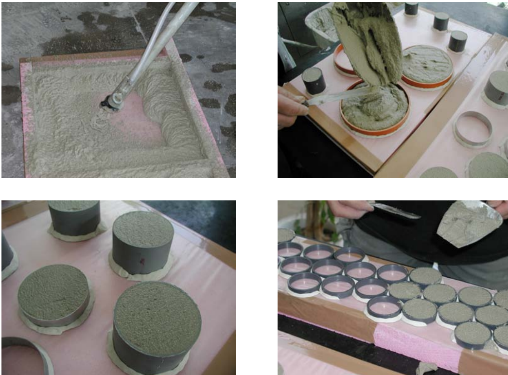
Abb. 23 Probekörperherstellung für die Ermittlung der Festigkeitswerte
