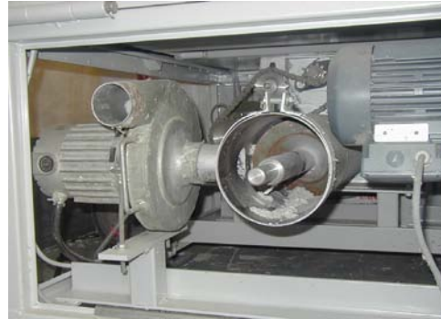
Abb. 10 Zentrale Förderschnecke mit Saugventilator
