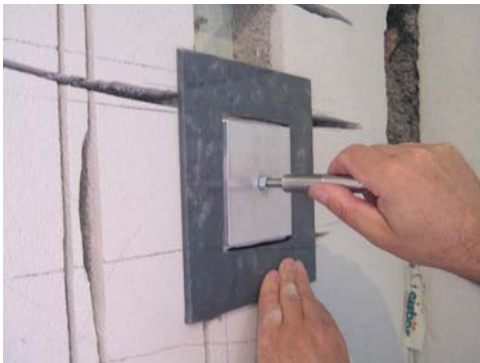
Abb. 41 Prüfkörper mit Alu-Platte und lastverteilendem Rahmen der Prüfmaschine
