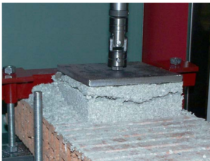
Abb. 39 Versagen der Probekörper im Material
