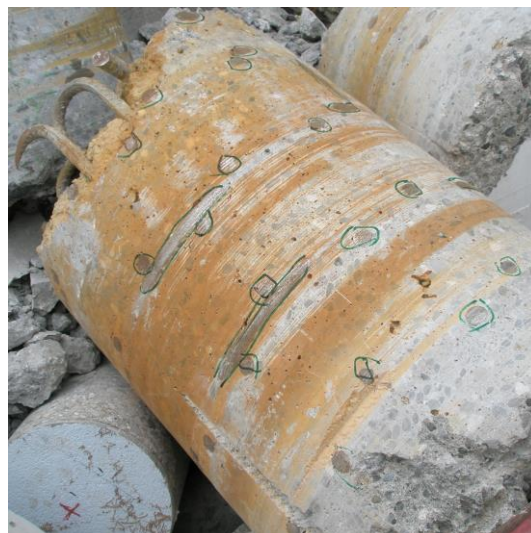
Abb. 65: Links – Einblick in eine Kernbohrung (Kernbohrservice) ; Rechts – Bewehrungsführung an einem Bohrkern erkennbar (Fraebag)
