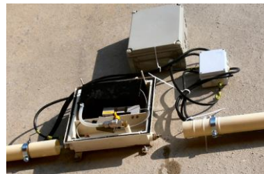
Abb. 104: Links – Schlauchwaagensysteme (Interfels) ; Rechts – Drucksystem (Shoef)
