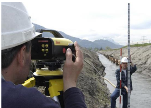
Abb. 103: Links - Nivellier zur Bestimmung von Höhendifferenzen (Leica Geosystems); Rechts – Digitalnivellier (Trimble)
