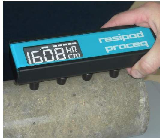
Abb. 122: Links – Korrosionsanalysegerät auf Basis der Potentialfeldmessung ; Rechts – Widerstandsmessgerät zur Erfassung des elektrischen Widerstandes von Betonbauteilen (Proceq)
