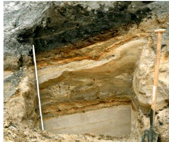
Abb. 74: Links – Schurf in Lockergestein; Rechts – Schichtenverlauf an der Wandung eines Baggerschurfs
