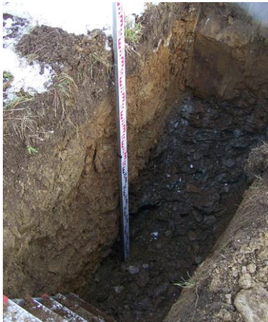
Abb. 74: Links – Schurf in Lockergestein; Rechts – Schichtenverlauf an der Wandung eines Baggerschurfs
