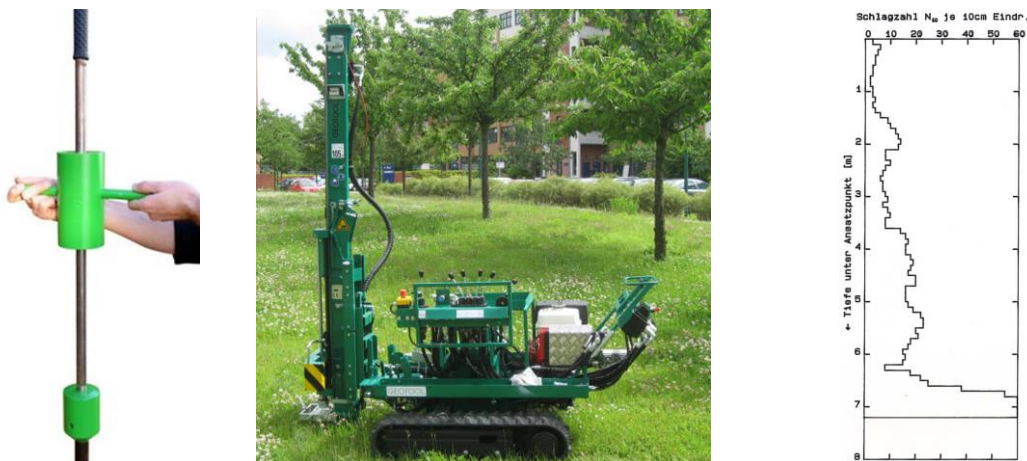
Abb. 71: Links – leichte Rammsonde - Künzelstab (Geotool) ; Mitte – schwere Rammsonde auf einem Raupenfahrwerk (Geotool) ; Rechts – Protokoll einer Rammsondierung (IGEWA)
