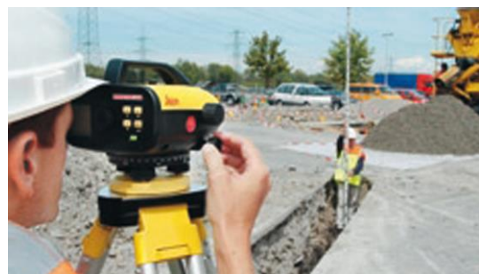
Abb. 61: Links – Bestimmung des Höhenunterschieds (Matthews, 1996) ; Verwendung eines digitalen Nivelliergeräts (Leica Geosystems)
