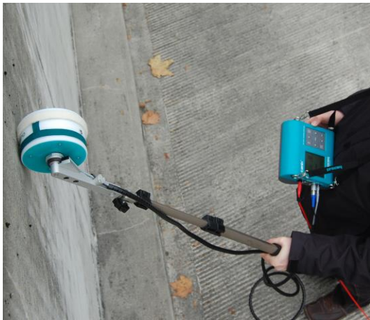
Abb. 122: Links – Korrosionsanalysegerät auf Basis der Potentialfeldmessung ; Rechts – Widerstandsmessgerät zur Erfassung des elektrischen Widerstandes von Betonbauteilen (Proceq)
