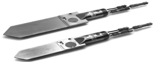
Abb. 116: Erddruckaufnehmer in Kombination mit einem Piezometer (Glötzl)
