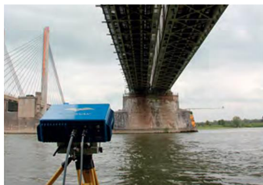
Abb. 101: SAR verwendet zum Brückenmonitoring (Metasensing, 2014)
