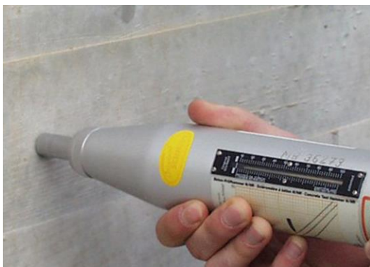
Abb. 70: Links – Rückprallhammer an einer Bauteiloberfläche (Bögl) ; Rechts – Umrechnungstabelle zwischen der Rückprallzahl und der Betondruckfestigkeit
