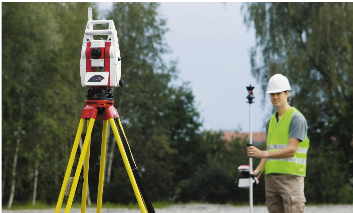
Abb. 63: Totalstation (Leica Geosystems)
