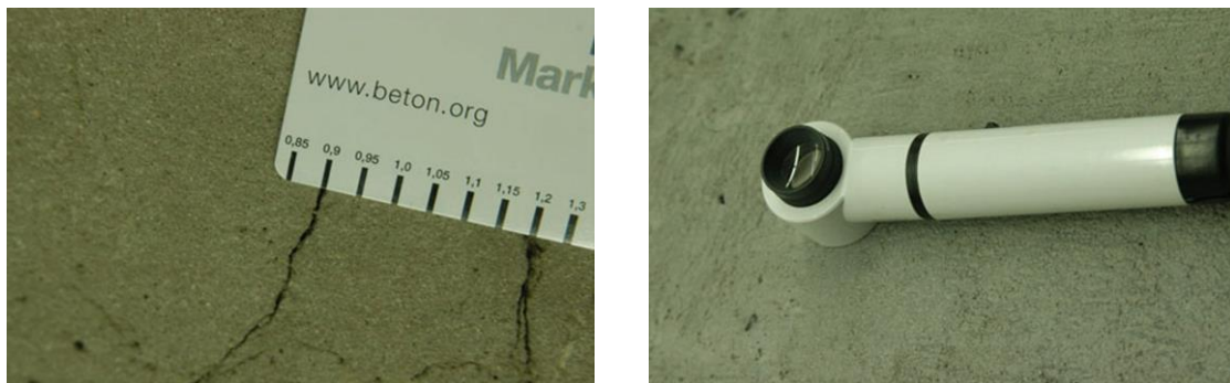
Abb. 66: Links – Rissbreitenvergleichsmaßstab; Rechts – Risslupe (Weber, 2013)
