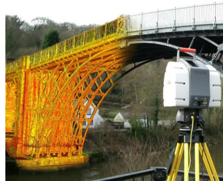
Abb. 100: Oben – Laserscanner (Laserscanning); Unten – Ergebnis eines Laserscans (GIS Blog)
