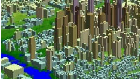
Abb.8: Ein stereo-photogrammetrisch erstelltes Stadtmodell von Philadelphia mit \pm 1 m Genauigkeit (© Vexcel Corp.).
