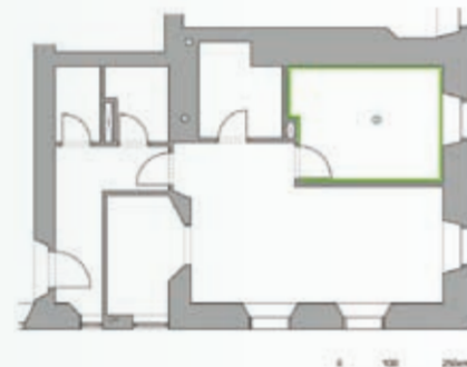
Abb. 6 Einblasöffnung in Raummitte (blau) und Fugenabdichtung (grün)
