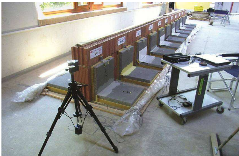
Dans les laboratoires pour la physique du bâtiment à l'Université technique de Graz, différents examens de séries de modèles ont été effectués pour constater l'influence des bandes d'étanchéité sur la transmission du son.
