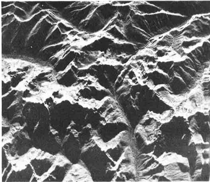
Figur 2.8: Beispiel eines Flugzeugradarbildes, das den Effekt der großen Variation des Blickwinkels demonstriert (Westinghouse AN-APQ 97, Yellowstone Park)
