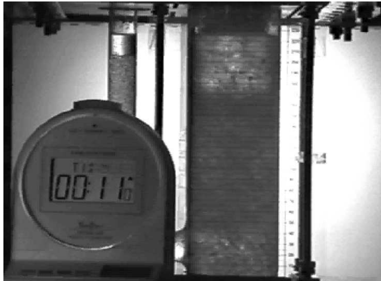
Abb. 3-8: Beispiel eines Absetzversuches mit Pall-Ringen aus PP
