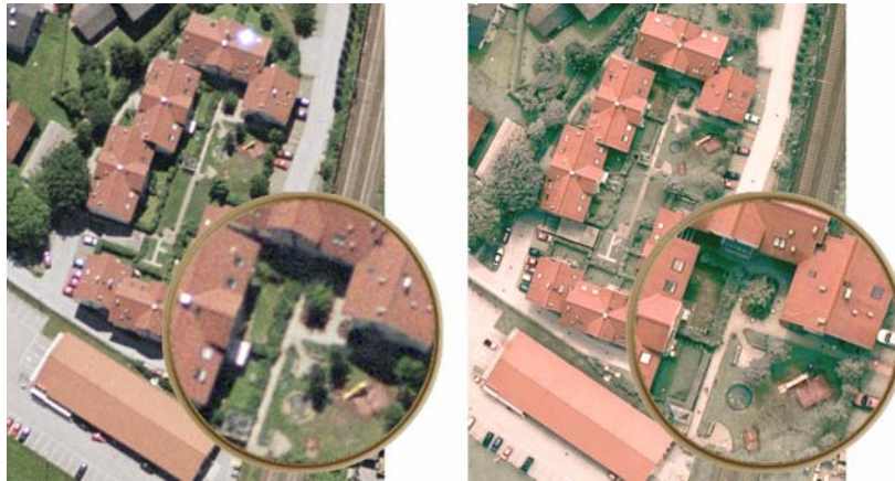
Abbildung 2: Analoge und digitale Luftbildaufnahmen im direkten Vergleich. Die analoge Aufnahme vom 6. Juli 2002 auf AGFA X100 Farbnegativfilm zeigt wesentlich weniger Details als die digitale Aufnahme vom 9. August 2002. Die Detailvergrößerung zeigt in beiden Fällen einen Bildkreis mit einem Durchmesser von 210 Pixel oder 31 Meter in 2-facher Vergrößerung.
