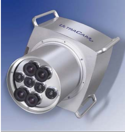
Abbildung 7: Ansicht der Sensoreinheit von unten. Im Sensor befinden sich 8 Objektive, davon dienen 4 für die panchromatische Aufnahme, 4 für die Aufnahme der 4 Farbkanäle rot, grün, blau und infrarot. Jedes Objektiv hat dasselbe Gesichtsfeld. In der Bildebene sind die Flächenarrays angebracht. Der panchromatische Konus mit 4 CCDs dient als „Masterkonus“ zur Festlegung des Bildkoordinatensystems.
