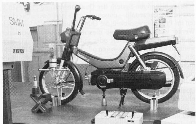
Bild 10. Messen des Fahrwerks eines Mopeds Maxi Plus
