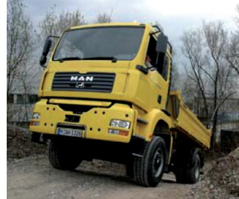
**Fig. 5 – MAN HydroDrive, una trasmissione add-on per doppia trazione opzionale, [6]**
