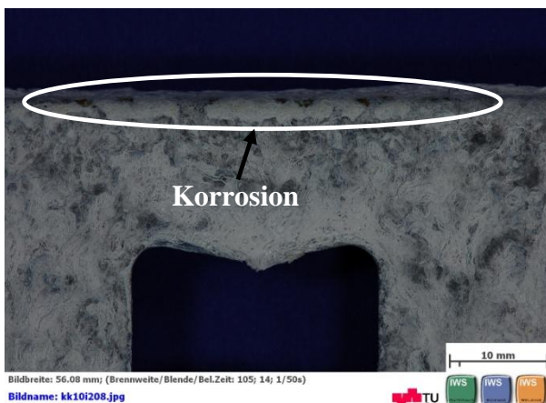
Abbildung 6: Bereich 3 Kantenkorrosion infolge Rotrost, Detail aus Abbildung 4
