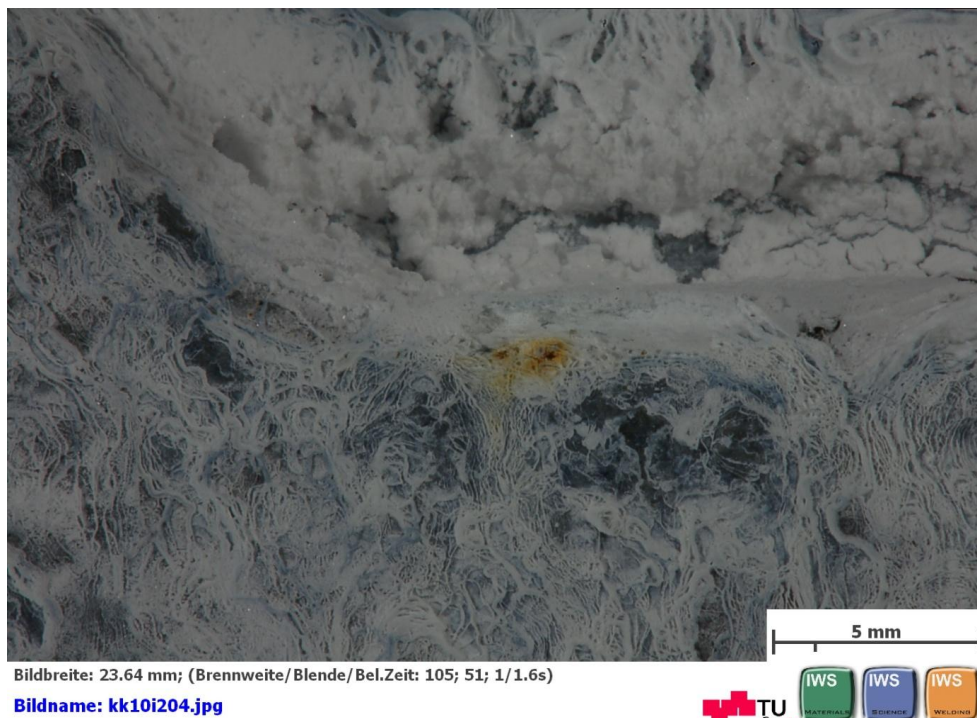
Abbildung 3: Detail 1 aus Abbildung 2 Weißrost mit lokaler Rotrostbildung
