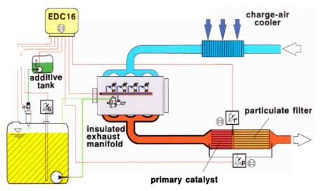
Figure 73: Fuel-Borne Catalysed Filter (Source: Bosch)
