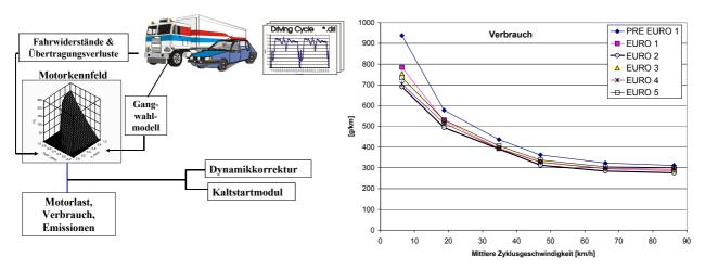
Abbildung E1: Schema des Modells PHEM (links) und simulierte Verbrauchswerte für die SNF-Kategorie "Lastenzüge und Sattel-KFZ 34-40t", halb beladen, 0% Fahrbahnlängsneigung
