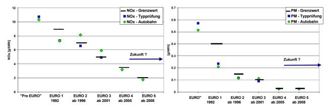
Abbildung E2: Entwicklung der Emissionsgrenzwerte, der Emissionsniveaus in den zugehörigen Typprüfzyklen und den für realen Autobahnverkehr berechneten Emissionen
