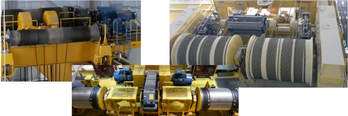
Bild 5: Seiltrommeln in Stahlwerken
