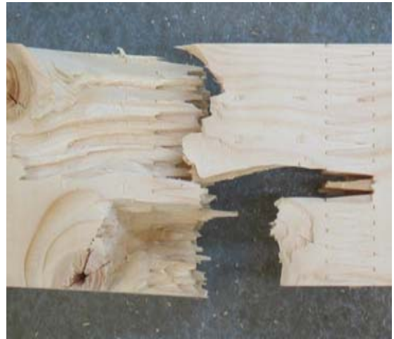
Abb. 5-32: P, Ai/nKZ; Zugbeanspruchung
