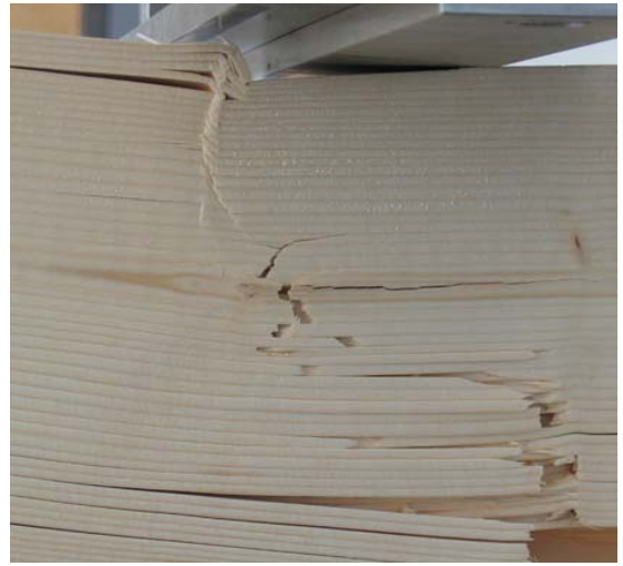
Abb. 5-33: Einpressungen im Bereich der Lasteinleitung; 4 Punkt Biegebeanspruchung
