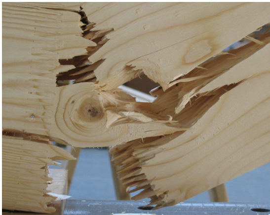
Abb. 5-9: LSF, P, Ai/nKZ; 4 Punkt Biegebeanspruchung
