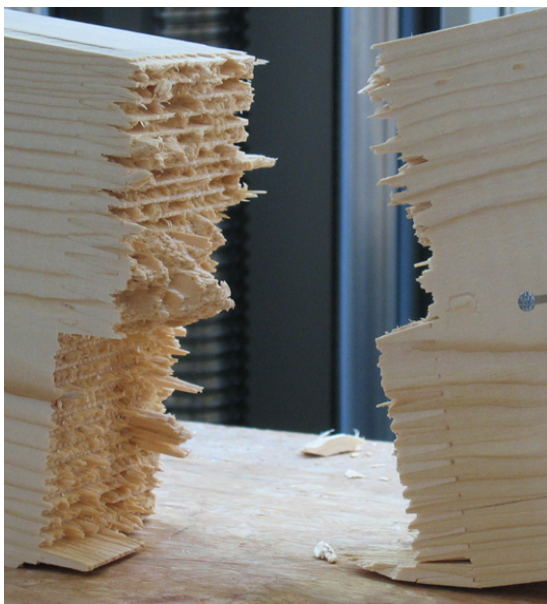
Abb. 5-27: ZGB; 4 Punkt Biegebeanspruchung
