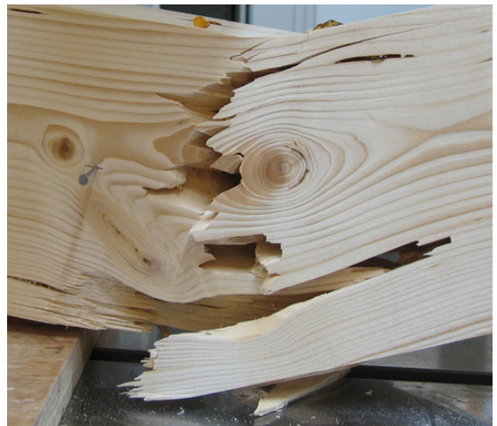
Abb. 5-24: LSF, WB; 4 Punkt Biegebeanspruchung
