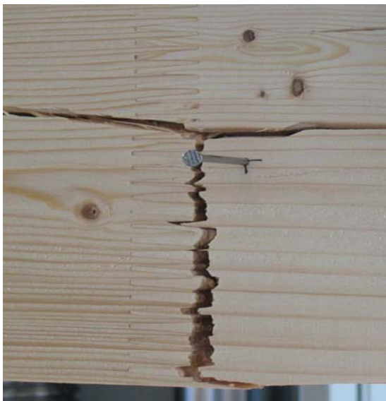
Abb. 5-26: ZGB; 4 Punkt Biegebeanspruchung
