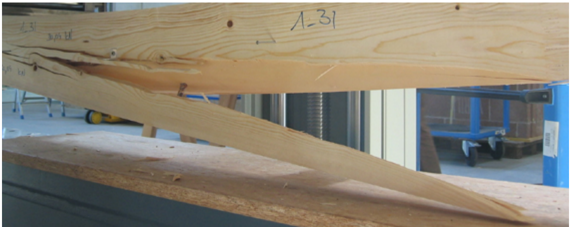
Abb. 5-17: GSF; 4 Punkt Biegebeanspruchung
