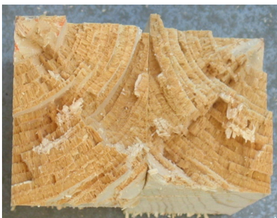
Abb. 5-22: HB, stumpfer Bruch; Zugbeanspruchung
