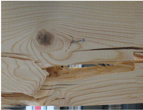
Abb. 5-8: LSF, SSA; 4 Punkt Biegebeanspruchung
