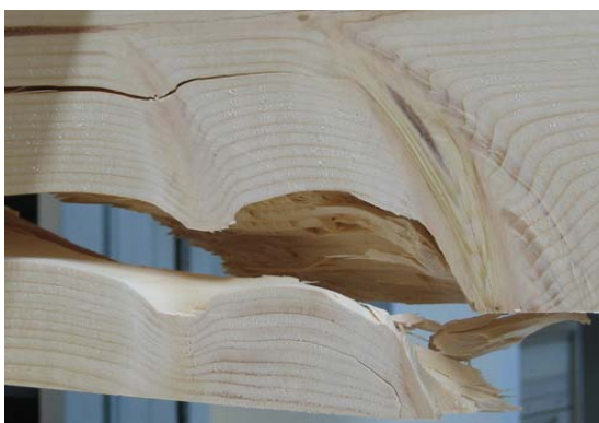
Abb. 5-10: LSF, SSA; 4 Punkt Biegebeanspruchung
