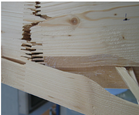
Abb. 5-21: S, Querschnittsverminderung trockener Riss; 4 Punkt Biegebeanspruchung
