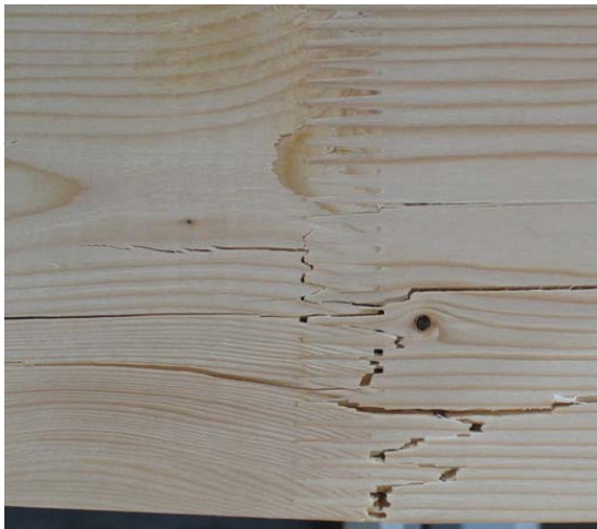
Abb. 5-31: P, Ai/nKZ, LSF; 4 Punkt Biegebeanspruchung
