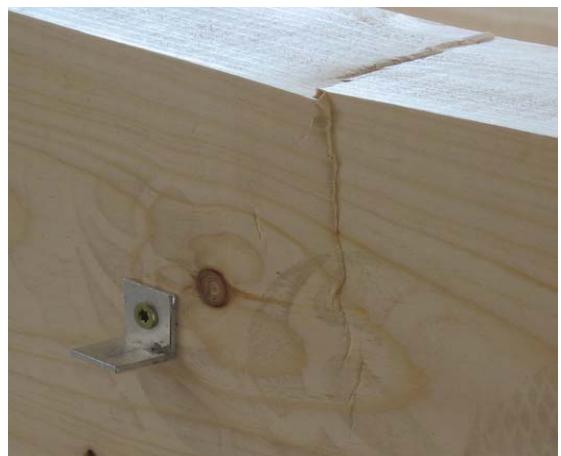
Abb. 5-25: DF, Versagen in der Druckzone; 4 Punkt Biegebeanspruchung
