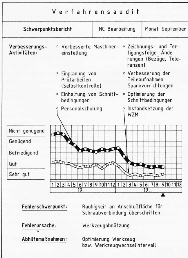
Bild 3. Verfahrensaudit-Bewertung mit getrennter Betrachtung von Verfahrensfähigkeit und Maschinenbedienung
