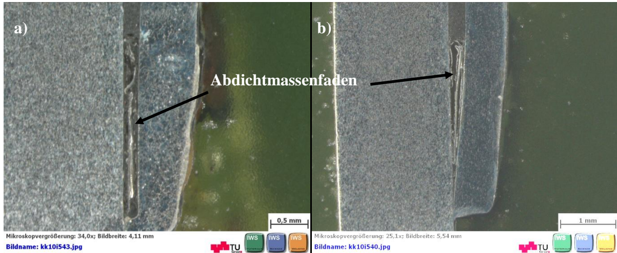
Abbildung 6 Spaltfüllung: a) Detail 13.3 aus Abbildung 13 von Seite 11 des Schliffs C; b) Detail 9.1 aus Abbildung 9 von Seite 9 des Schliffs D
