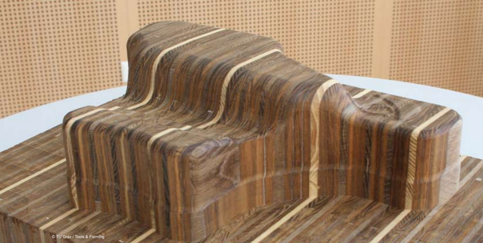
Abb. 2: Als Halbzeug für die Fertigung des Stempels kamen Blöcke aus orthogonal zu ihrer Faserrichtung angeordneten 4,5 mm dicken Robinienfurnieren zum Einsatz.
