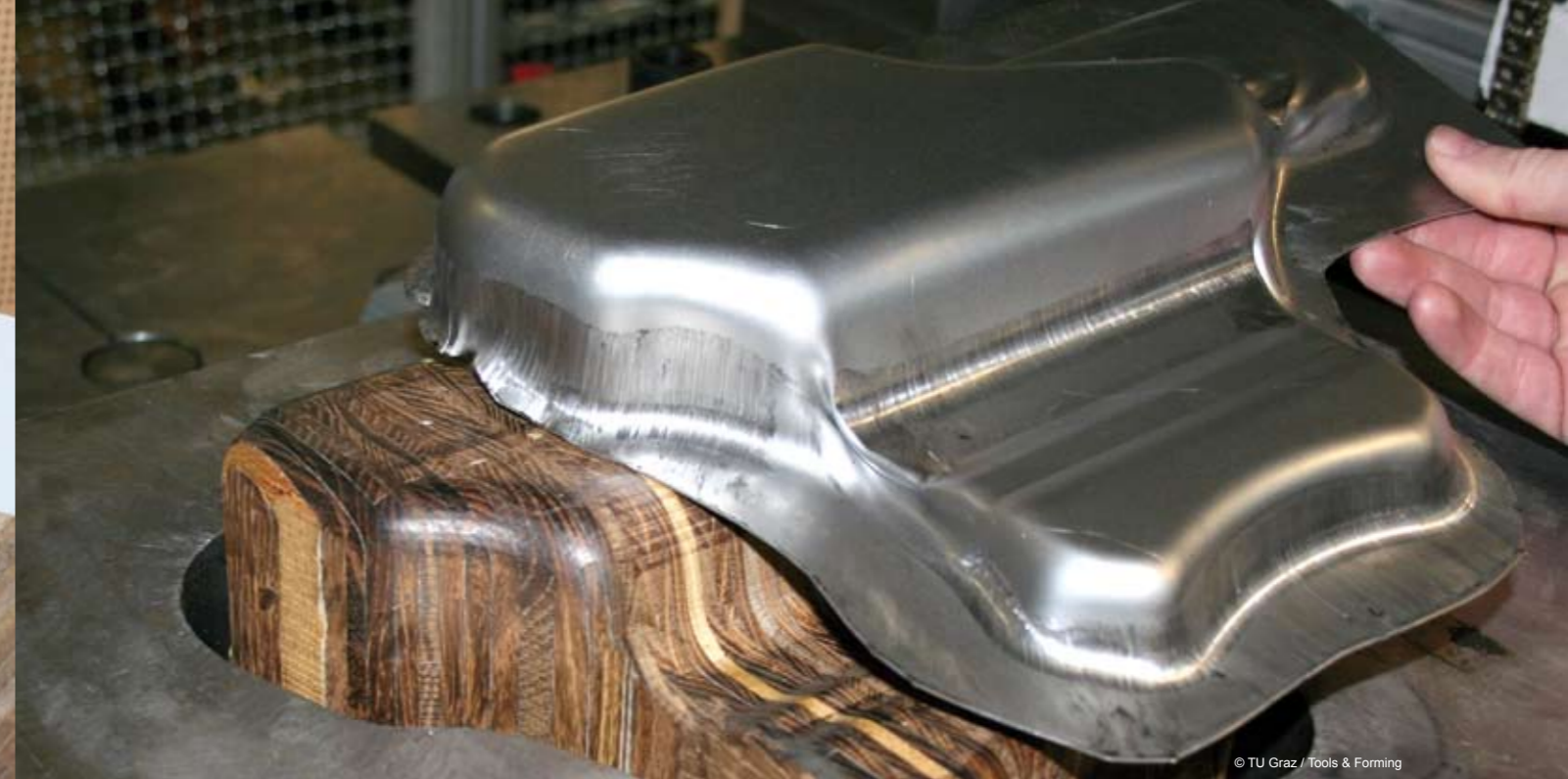
Abb. 3: In einer Versuchsreihe mit 200 umgeformten Bauteilen wurde die Machbarkeit des Verfahrens nachgewiesen.
