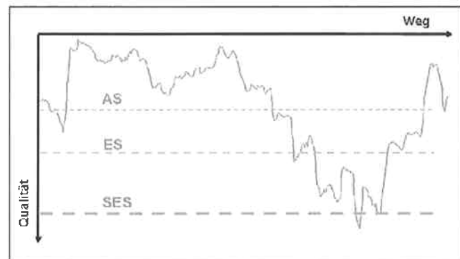
Abb. 1. Isolierte Betrachtung von Messfahrten (Qualitäts-Weg-Diagramm) unter Berücksichtigung der Eingriffsschwellen (AS, ES, SES)
