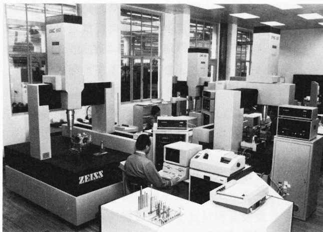
图 4 a 装有三坐标测量中心的计量室，用于协调发动机和减速箱元件的机械制造
