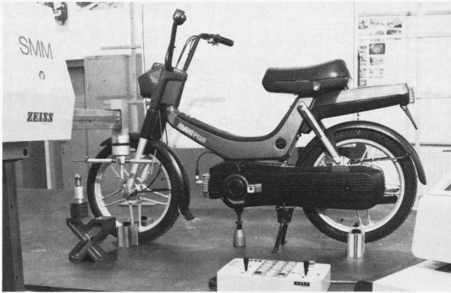
图9 对Puch Maxiplus 进行调整检验
