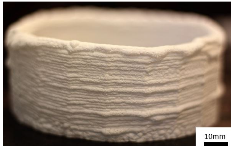
Abbildung 4.57: Hergestellter elliptischer Hohlzylinder - strahlartige Oberflächenstruktur (Quelle: Eigene Darstellung)
