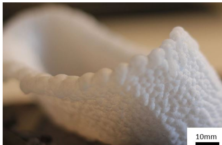
Abbildung 4.58: Hergestellter elliptischer Hohlzylinder - tropfenartige Oberflächenstruktur (Quelle: Eigene Darstellung)
