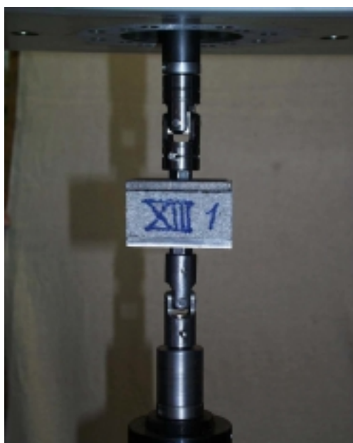
Abb. 53 Eingebauter Zelluloseprüfkörper vor dem Lastspiel
