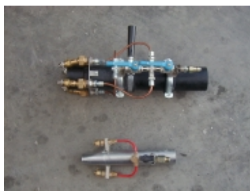
Abb. 19 4er Düse „Terminator“ der Firma Isofloc und 2er Düse
