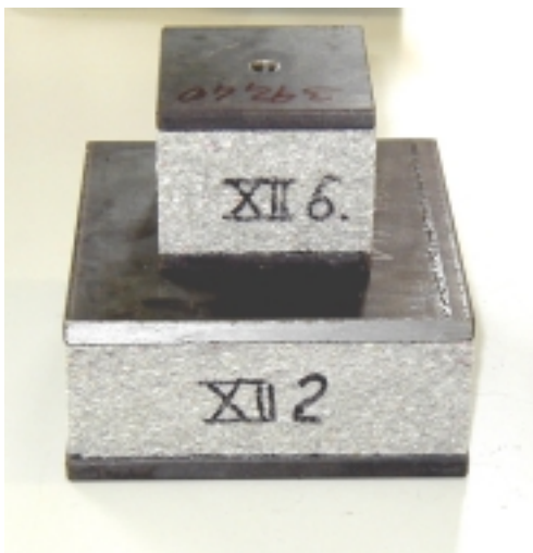
Abb. 51 Prüfkörper 8 x 8 und 15 x 15 cm
