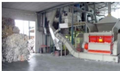
Abb. 11 Anlieferung und Grobzerkleinerung des Zeitungspapiers im sog. Shredder
