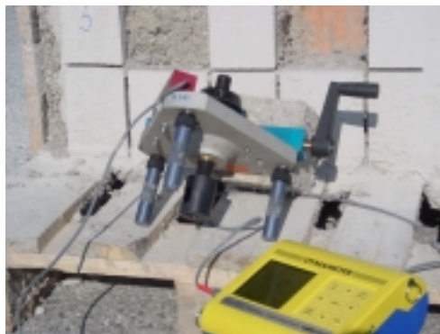
Abb. 67 Abzugsgerät für die in-situ-Versuche
