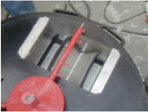
Abb. 22 X-Floc Zellofant, Zelleradschleuse
