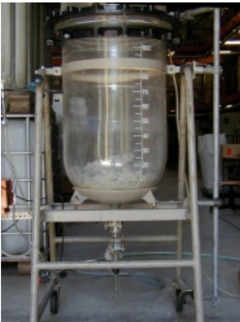
Abb. 36 100 l Versuchsreaktor Die drehbare Düse im Zentrum der Flocken wird von unten mit Pressluft versorgt.
