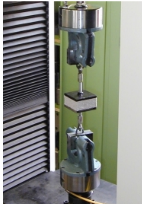
Abb. 48 Bestimmung der Zugfestigkeit normal zur Probenebene
