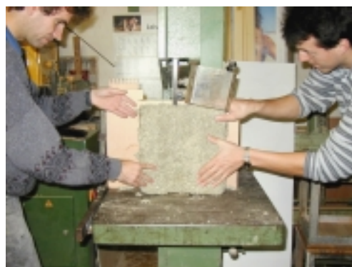
Abb. 42 Herstellung plattenförmiger Prüfkörper
