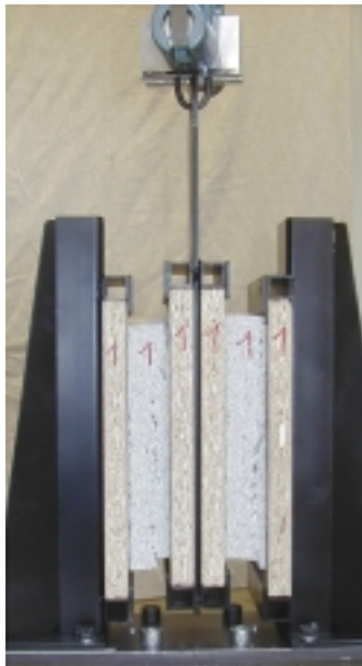
Abb. 50 Bestimmung der Scherfestigkeit
