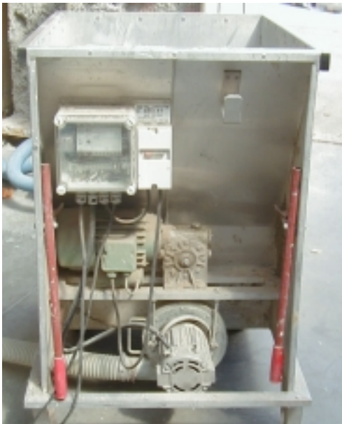
Abb. 24 Einblasmaschine ohne Zelleradschleuse
