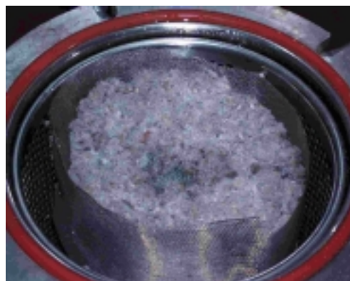
Abb. 41 Zelluloseprobekörper nach der Bedampfung
