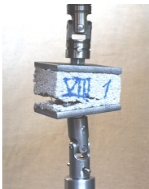
Abb. 54 Eingebauter Zelluloseprüfkörper nach dem Lastspiel
