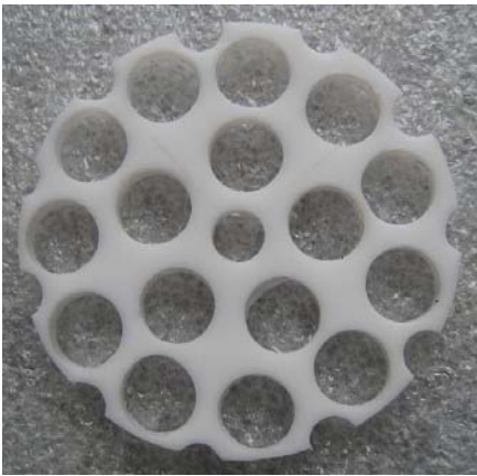
Bild 5.21 Siebboden aus PTFE
