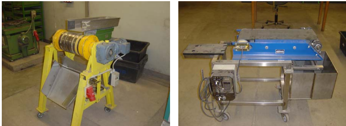
Bild 4.4 Magnettrommel und Hochgradient-Magnetscheider
