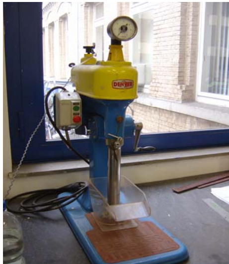
Bild 4.3 Flotationsmaschine und Rotor-Stator-System
