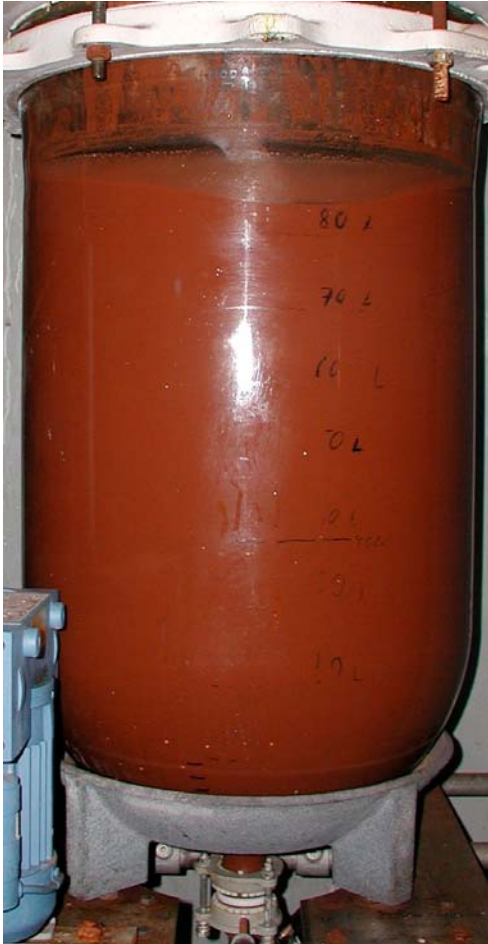
Bild 5.18 Laugung der Klärschlammasche
