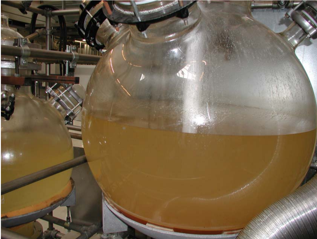
Bild 5.33 Organische und wässrige Phase nach der Reextraktion
