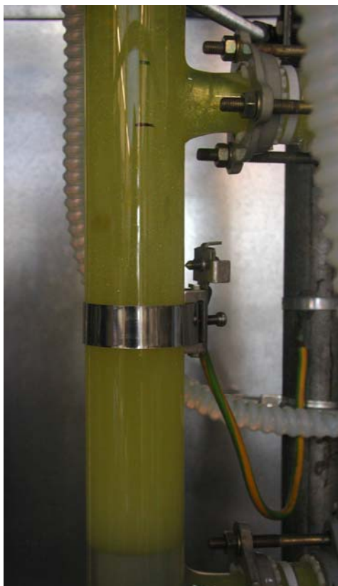
Bild 5.28 Fluten der Kolonne ohne Einbauten
