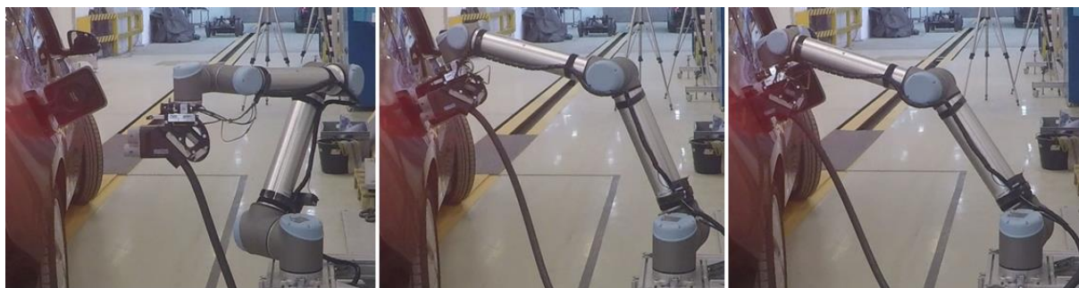
Abb. 9: Anstecksequenz des Laderoboters
