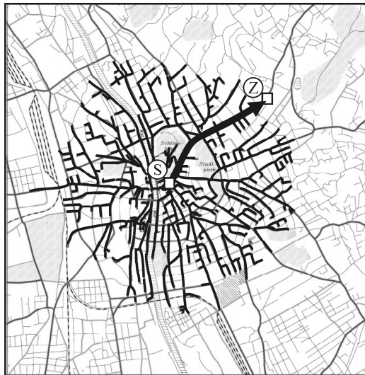
Abb. 3: Suchbaum zur Ermittlung der optimalen Route vom Start „S“ zum Ziel „Z“.
