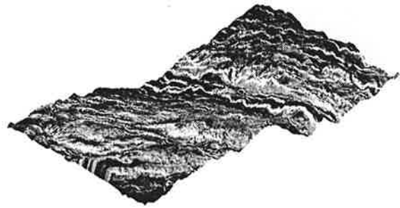
Abbildung 22 3-dimensionale Rekonstruktion durch Kombination von Stereo und Shape-from-Shading, hergestellt aus Abb.21.
