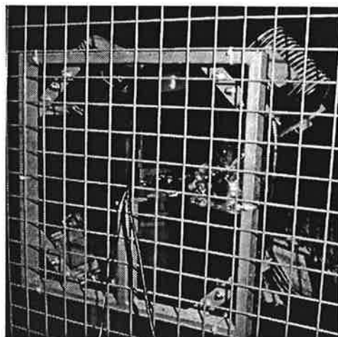
Abbildung 8 Kamera und Beleuchtung sind innerhalb des Schutzgitters angebracht, um das vom Roboter gehaltene Werkstück abzubilden
