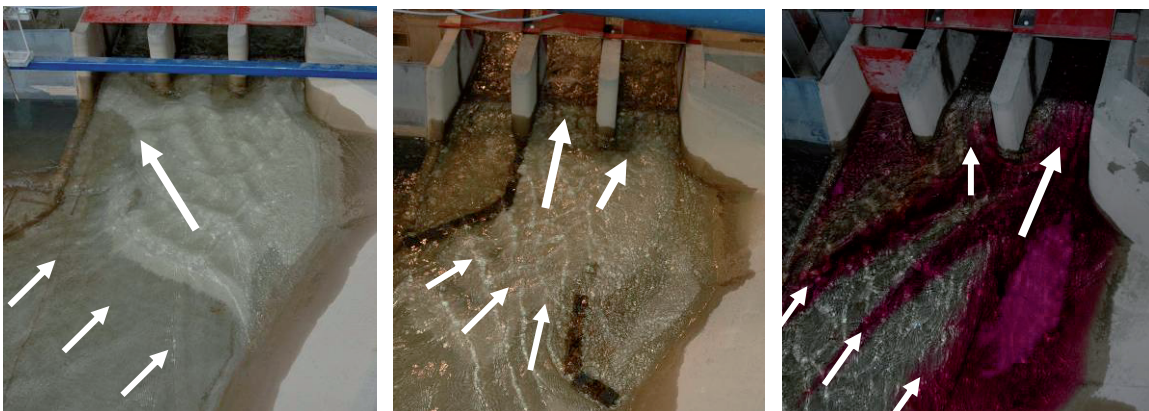
Abb. 5: Wehrfelder OW-seitig: Ausgangszustand (links), Leitwerke (Mitte), geschlossenes
