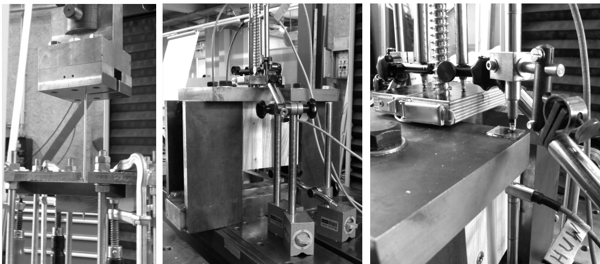
a) Haltevorrichtung \varnothing 6 \text{ mm} b) Haltevorrichtung für \varnothing 20 \text{ mm} c) Klemmvorrichtung an Gewindestange Abb. 1: Prüfkonfiguration für die Ausziehprüfungen nach ON EN 1382: 1999
