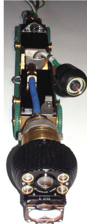
Abb. 4: Inspektionskamera mit Satellit zur Hausanschlussinspektion
