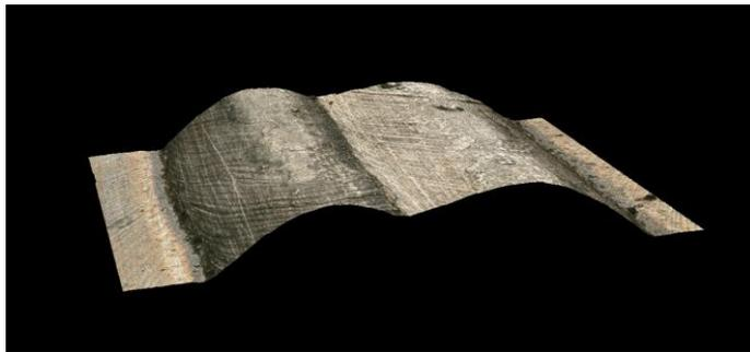
3D Oberfläche  $I = 190 \text{ A}$   $v_s = 0.75 \text{ cm/s}$   $\eta = 70\%$
