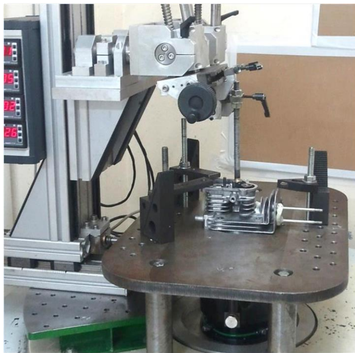
Abbildung 4-39: Zylinderkopf des Rasenmähermotors am Strömungsprüfstand
