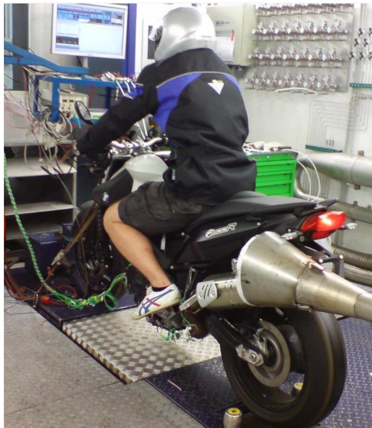
Abbildung 3-5: Motorrad am Rollenprüfstand
