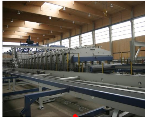
hydraulic CLT press
