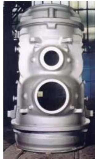
Skærbæk und Nordjylland, HP/IP- Gehäuse 20 t, (G-X12CrMoVNbN9-1)
