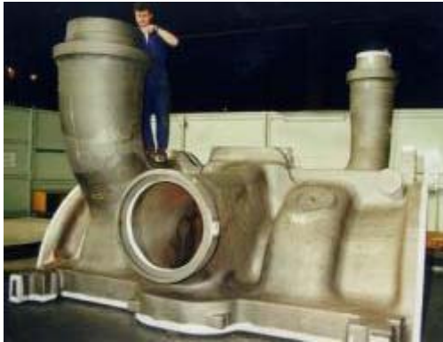
„Schwarze Pumpe“, IP Innengehäuse, 40 t (G-X12CrMoWVNbN10-1-1)
