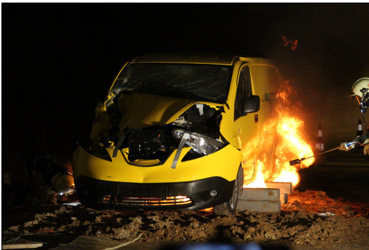
Abbildung 52: BV02, Entzündung des Fahrzeuges ausgehend von der Batterie
