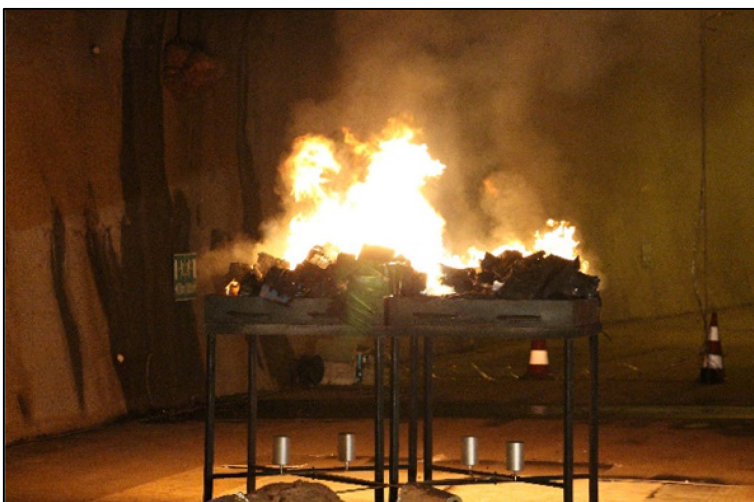
Abbildung 43: Brandversuch BP01 mit LFP-Zelltyp
