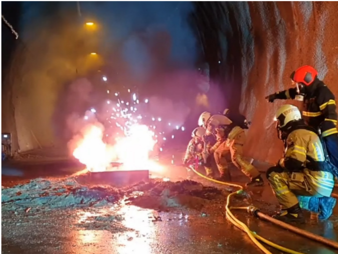
Abbildung 71: Einbringung der Löschanze
