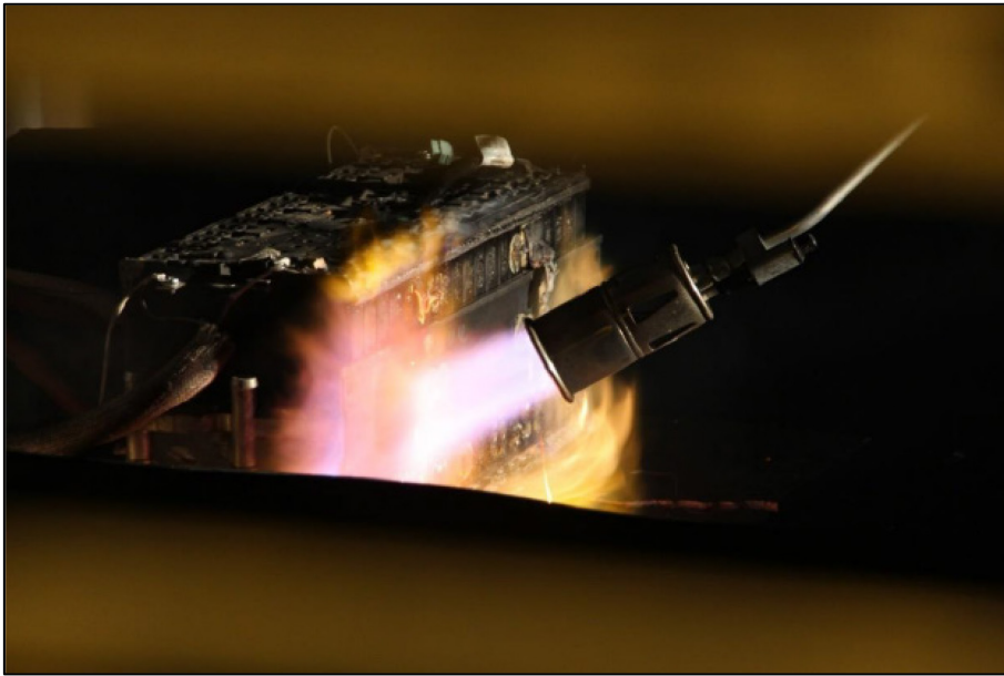
Abbildung 37: Erhitzung des Versuchsträgers mittels Gasbrenner
