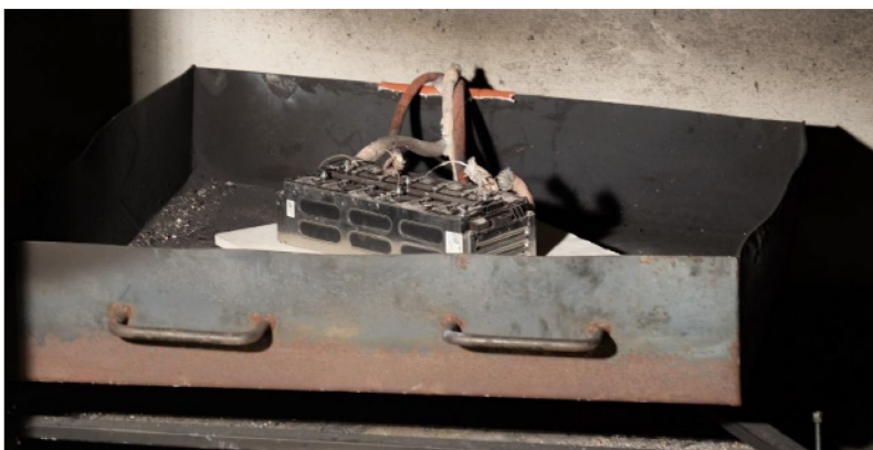
Abbildung 35: Spannungsmessung an einem Modul
