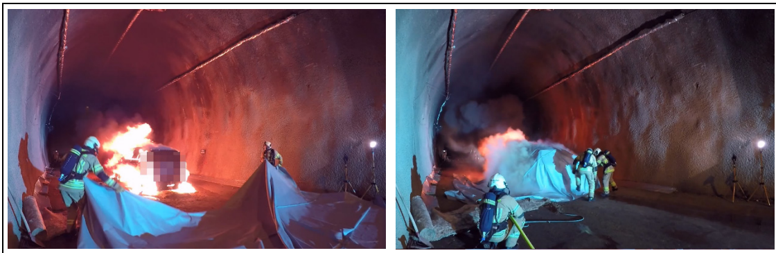
Abbildung 67: Brand des BEV vor und nach Anwendung der Löschdecke
