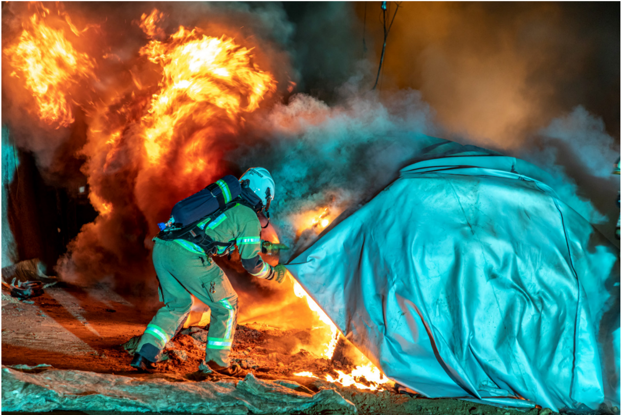
Abbildung 66: Löschdecke auf BEV (© TU Graz, Lunghammer)
