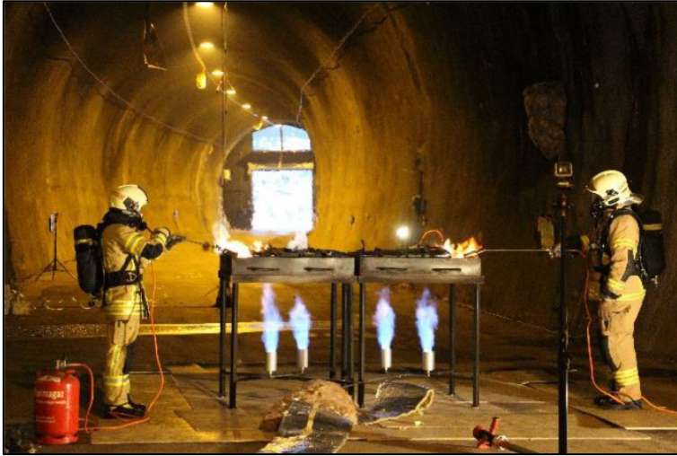
Abbildung 42: Erhitzung der Versuchsträger mittels Gasbrenner
