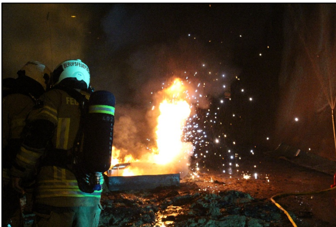
Abbildung 70: Zündung der Batterie durch spontane Kurzschlussreaktionen nach Einfüllen von \text{NaCl}_{aq}
