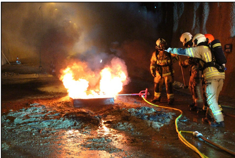
Abbildung 45: Brandversuch BP03 mit Anwendung der Löschlanze
