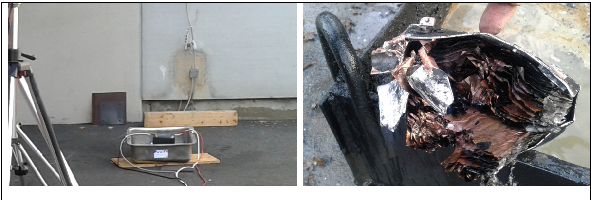
Abbildung 32: Versuchsaufbau mit Batterie-Zellen (links), Versuchsträger nach vollständigem Abbrand (rechts)
