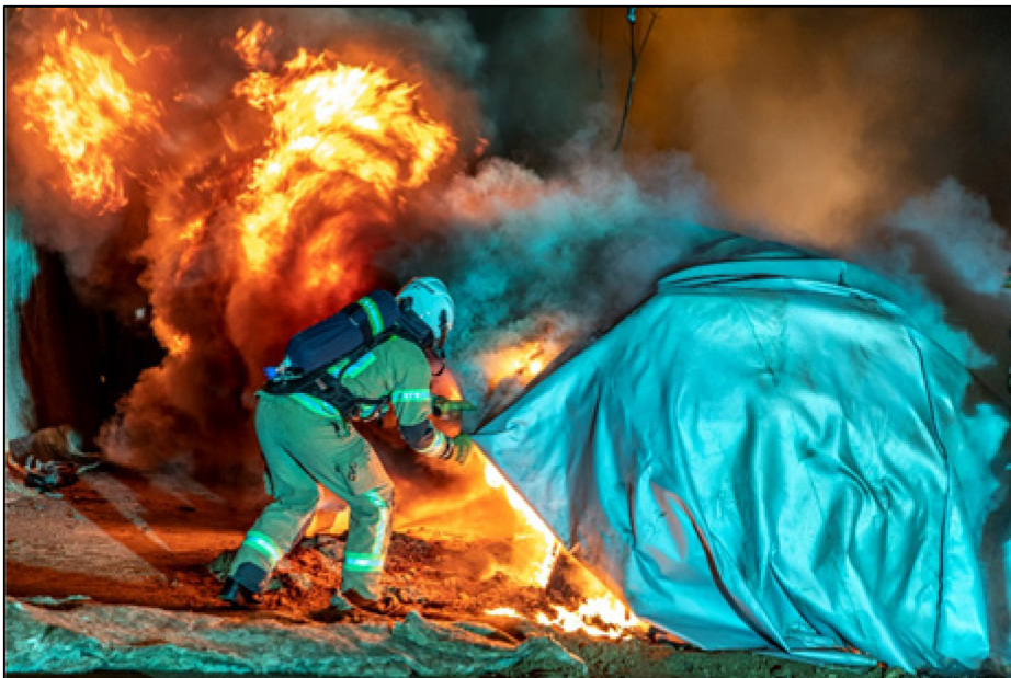
Abbildung 51: BV01, Anwendung der Löschdecke (© Lunghammer, TU Graz)
