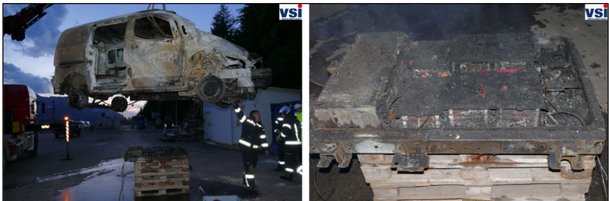
Abbildung 109: Versuchsträger nach dem Brandversuch (links) sowie Batterie im ausgebauten aber noch glühendem Zustand (rechts)
