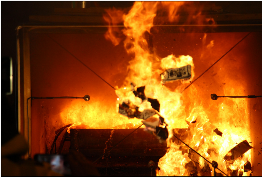
Abbildung 38: Heftige Brandreaktion eines NMC-Batterietyps
