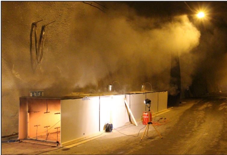
Abbildung 34: Testtunnel für die Ermittlung des Brandverhaltens verschiedener Module.
