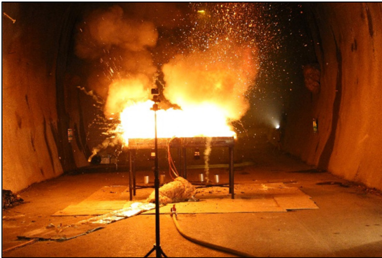
Abbildung 44: Brandversuch BP02 mit NMC-Zelltyp
