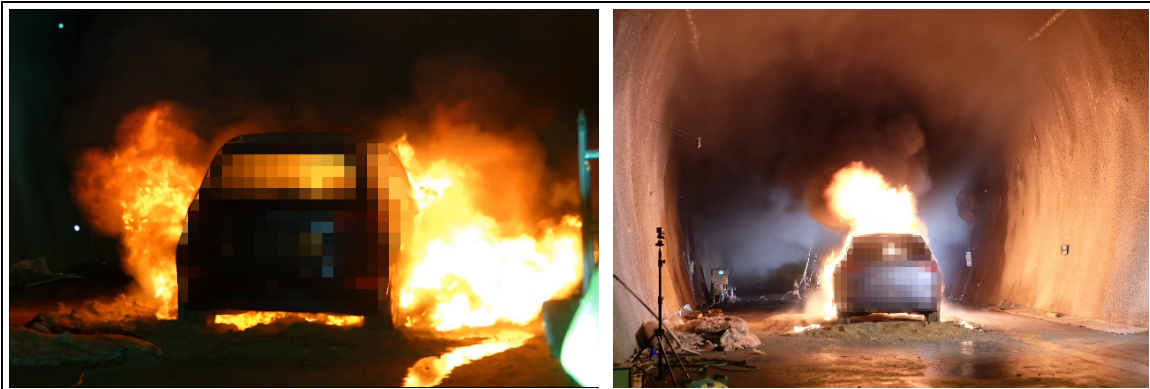
Abbildung 65: Vergleich Flammenbild Batteriebrand (links) und Brand des Innenraumes (rechts)
