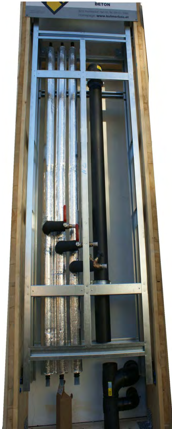
Abbildung 44: Ausschnitte der Fertigung des Prototyps eines vorgefertigten Haustechnikelements (Quelle: AEE INTEC)
