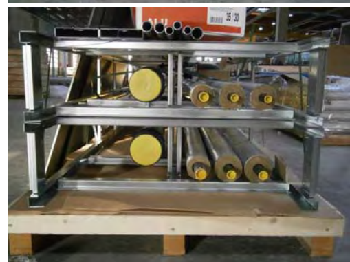
Abbildung 44: Ausschnitte der Fertigung des Prototyps eines vorgefertigten Haustechnikelements (Quelle: AEE INTEC)
