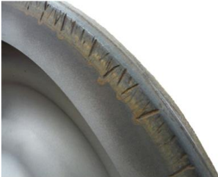
Abbildung Anhang 13: Beschädigung des Spurkranzes 165
