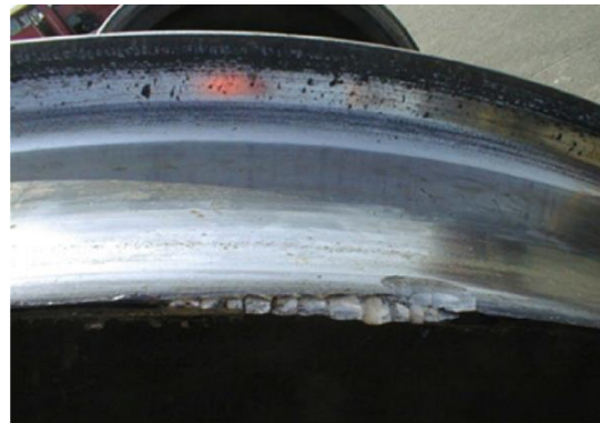
Abbildung Anhang 10: Ausbröckelung an der Fase 162
