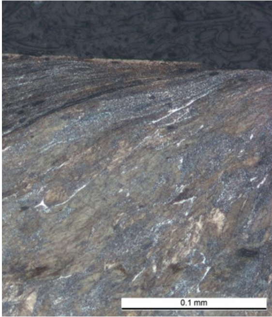
Abbildung 18: Schliffbild von perlitischem Gefüge 42
