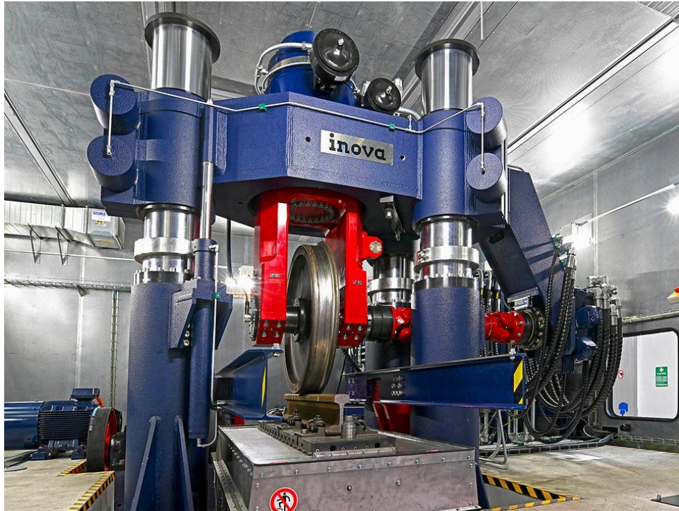
Abbildung 28: Rad-Schiene-Prüfstand B der DB 67
