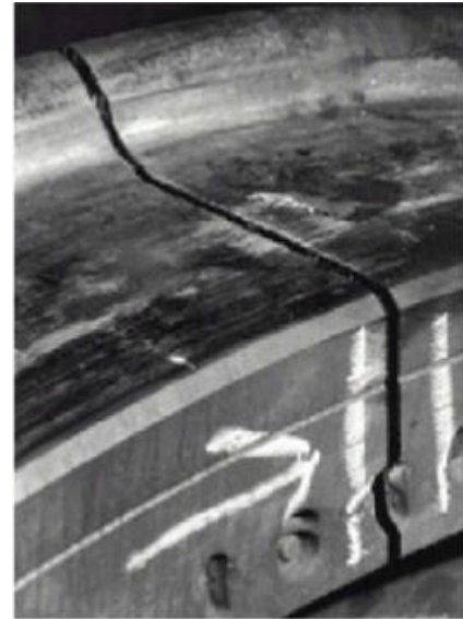
Abbildung Anhang 14: Schaden ausgehend von Kennzeichnung 166
