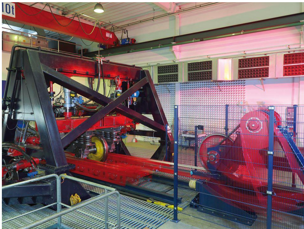
Abbildung 29: Rad-Schiene-Prüfstand A (linear) der DB 68
