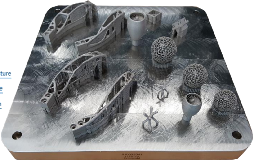
SLM-Teile nach dem Druckprozess Quelle: AddLab@tugraz, IFT
