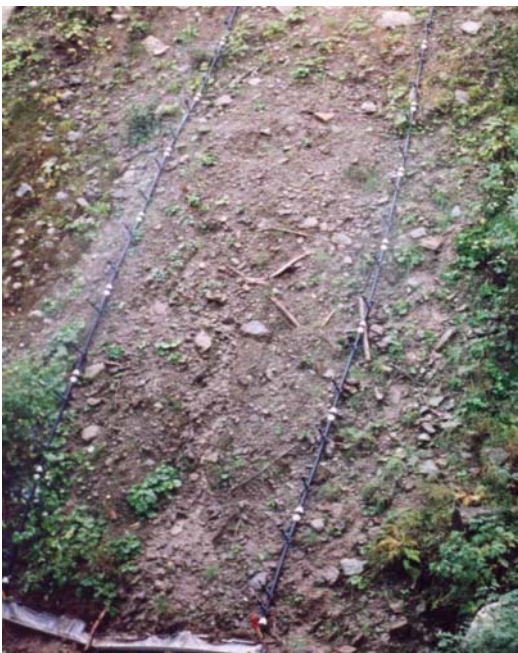
Abbildung 5.8a Beregnungsfläche BF6 – Blaike; geschütteter Rohboden
