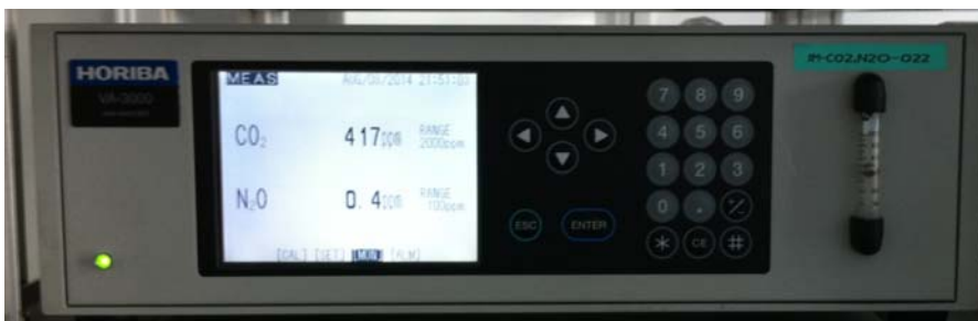
Abbildung 5: Horiba Kohlenstoffdioxid Analysator VA-3000 im Tunnel Kaisermühlen
