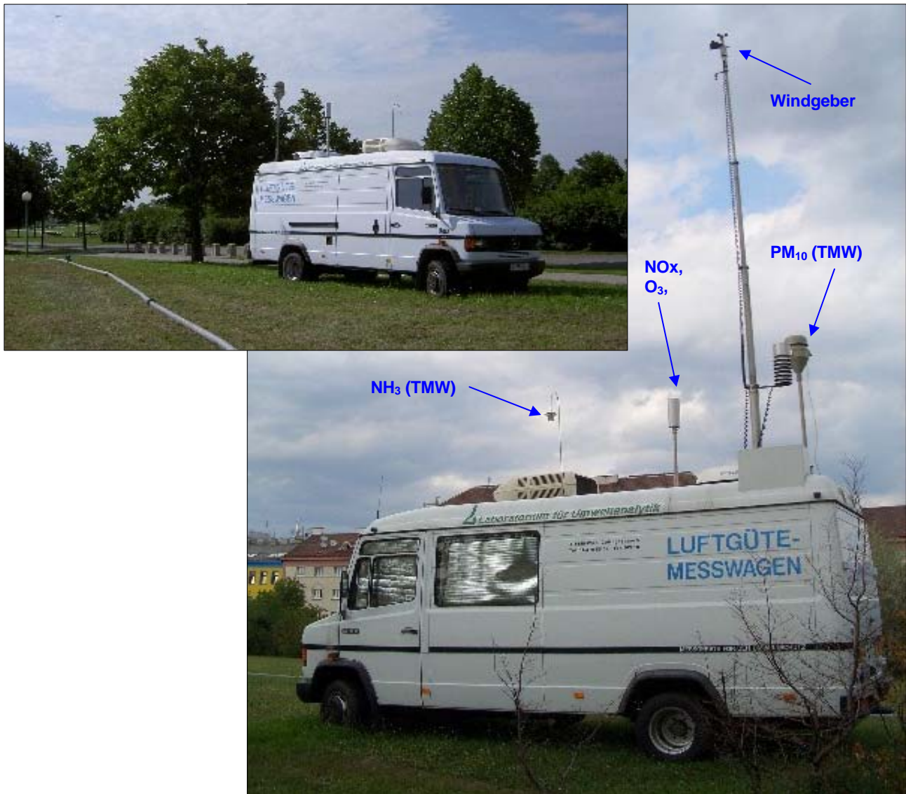
Abbildung 3: Luftgütemesswagen - Vorbelastungsmessstelle Kaisermühlen. Oben: vor Beginn der Immissionsmessungen, Blick Richtung Süd-West (Neue Donau). Rechts: Blick Richtung Nord-Ost (Alte Donau). Probenluftzuleitungen gekennzeichnet.
