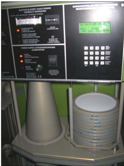
Abbildung 8: DIGITEL High Volume Sammler DHA-80, Innenansicht des automatischen Filterhalterwechslers. Konische Ansaugleitung links unten, Stapel an unbeprobten Filtern rechts unten.
