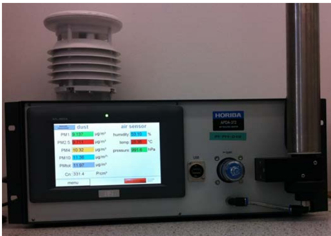
Abbildung 5: Kontinuierlich arbeitendes Staubmessgerät zur Erfassung von PM 1 , PM 2,5 , PM 10 und TSP im Lainzer Tunnel.
