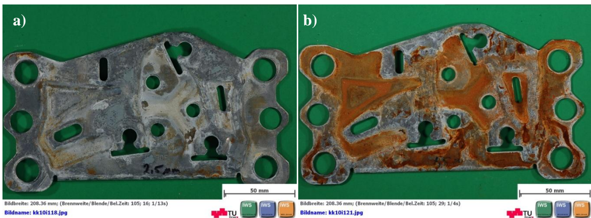
Abbildung 4 Draufsicht NSS nach 24 Std. liegend: a) Probe 4 b) Probe IV
