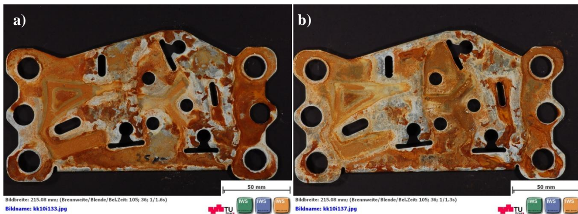
Abbildung 7 Adapterplatte nach 48 Stunden NSS-Test liegend eingebaut: a) Probe 6 b) Probe VI
