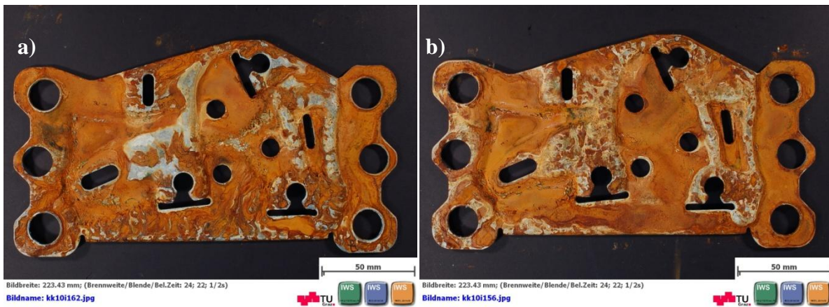
Abbildung 9 Adapterplatte nach 72 Stunden NSS-Test liegend eingebaut: a) Probe 4 b) Probe IV
