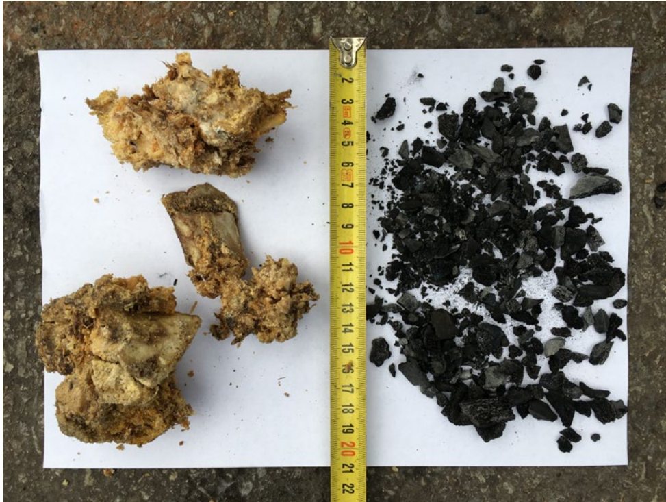
Foto: Schlachtabfälle als Eingangsstoff in den Pyrolysereaktor (links) und produzierte Biokohle (rechts) Quelle: Sonnenerde GmbH
