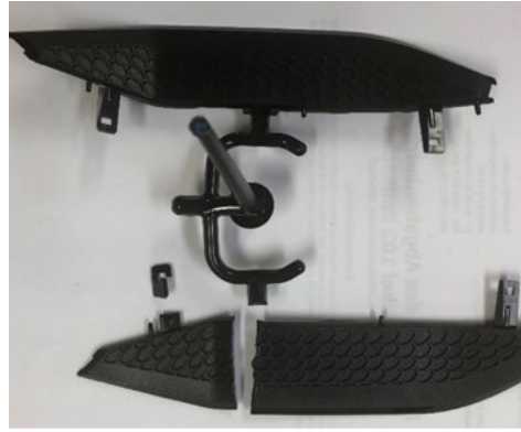
Fotos: Untersuchung von Coinjection zur Abfederung schwankender Materialgüte im Scheinwerfer Quelle: ZKW Group GmbH
