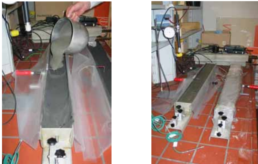
Abbildung 4.7: Schwindrinnenbefüllung und Lagerung
