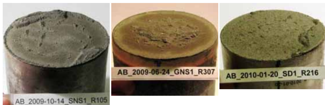
Abbildung 5.48: Bruchflächen der Werkstoffkombinationen a) SRXEM, b) GRXEM, c) SRXDM in schräger Ansicht
