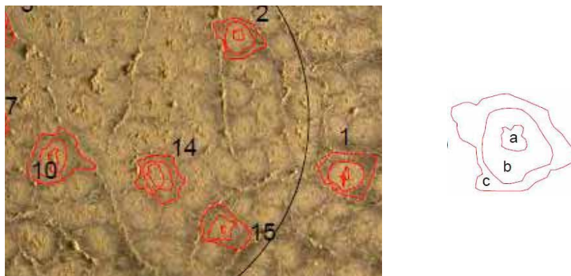
Abbildung 5.46: Vermessung der Flächenanteile mit Bruchformen fI (blank abgelöst, hier „c“) und fII + b (Anhaftendes, hier „a + b“) der polygonalen Rissfelder.
