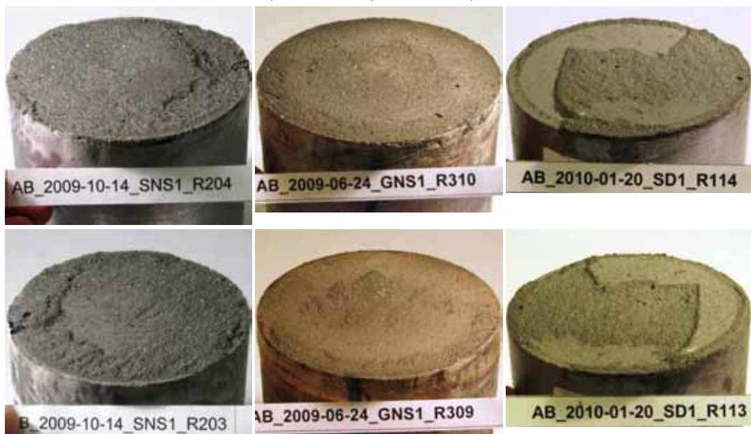
Abbildung 5.35: Beispiele raue Oberflächen, oben: : Probekörperoberteile, unten: Probe- körperunterteile a) SR2EM, b) GR3EM, c) SR1DM
