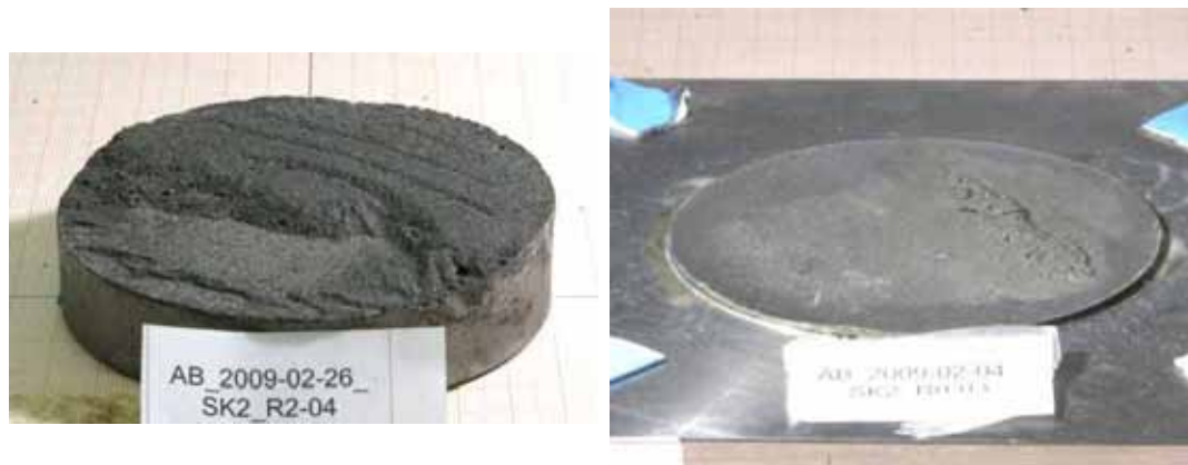
Abbildung 5.52: von Biegeeffekten beeinflusste Bruchformen der Vorserien
