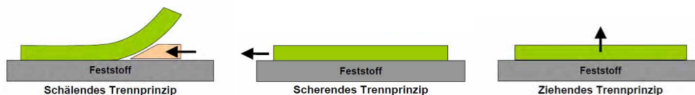
Abbildung 2.6: Trennprinzipien zum Prüfen der Adhäsionskraft von Klebungen aus [Burbaum 2009]
