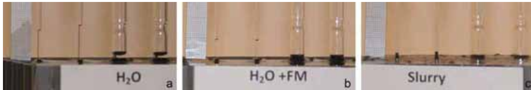
Abbildung 4.16: Versuche zur kapillaren Steighöhe mit verschiedenen Flüssigkeiten
