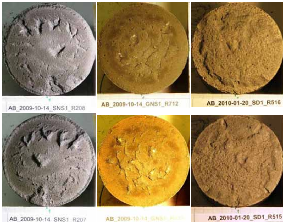
Abbildung 5.47: Bruchflächen der Werkstoffkombinationen a) SRXEM, b) GRXEM, c) SRXDM; obere Reihe: Probekörperoberseite, untere Reihe: Probekörperunterseite
