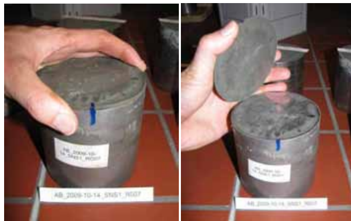
Abbildung 5.21: a) Probekörperunterteil aus Serie SNS1 nach Haftzugprüfung. \sigma_{\text{HZ}} = 4,6 \text{ N/mm}^2 , b) Ablösen der UHPC-Schicht 1 Tag nach HZ-Prüfung, \sigma_{\text{HZ}} \approx 0 \text{ N/mm}^2 .
