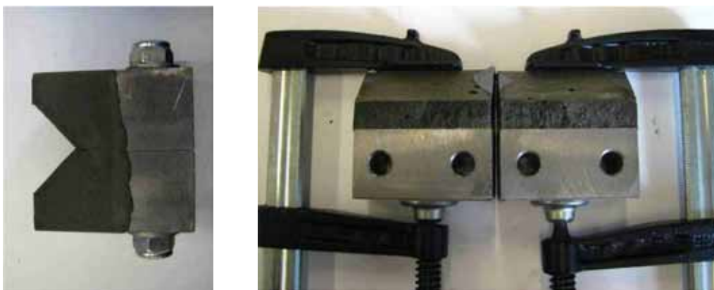
Abbildung 6.28: Brechen der Mikroskopie-Proben
