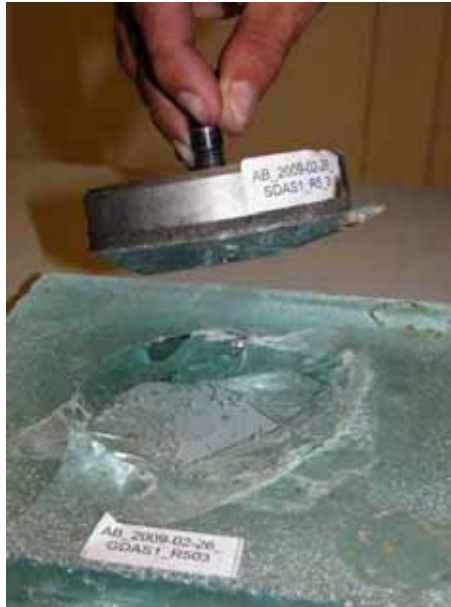
Abbildung 5.18: Kegelstumpf-förmiger Glasausbruch einer Probe aus Stahl_R1-UHPC-Glas_R5, [Staudacher 2009] vgl. Ausbruchskegel eines Dübel-Auszugversuchs
