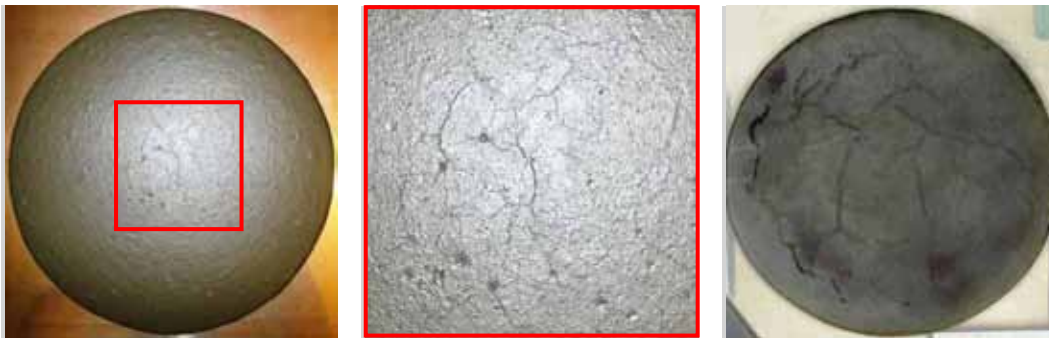
Abbildung 4.11: a) Ausbreitkuchen 1 h nach Betonherstellung, b) Risse im Zentrum von a), c) Unterseite Ausbreitkuchen im Alter von rund 4 Wochen
