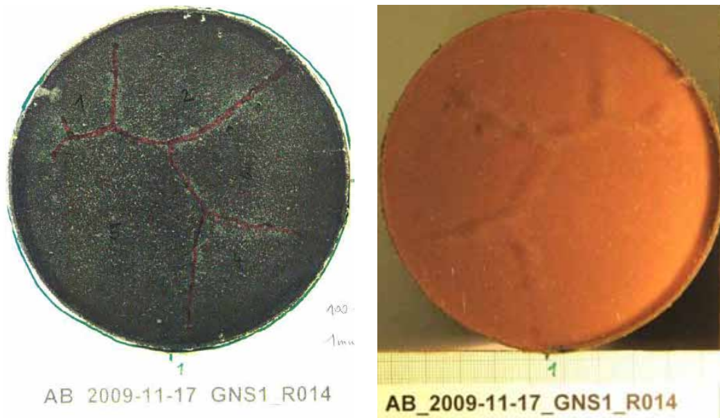
Abbildung 5.33: a) Rissmuster in UHPC-Scheibe MVS, entsteht erst durch sekundäres, oberflächlich einseitiges Trocknen, b) anhaftende Rissspuren auf Glas, nach Ablösung
