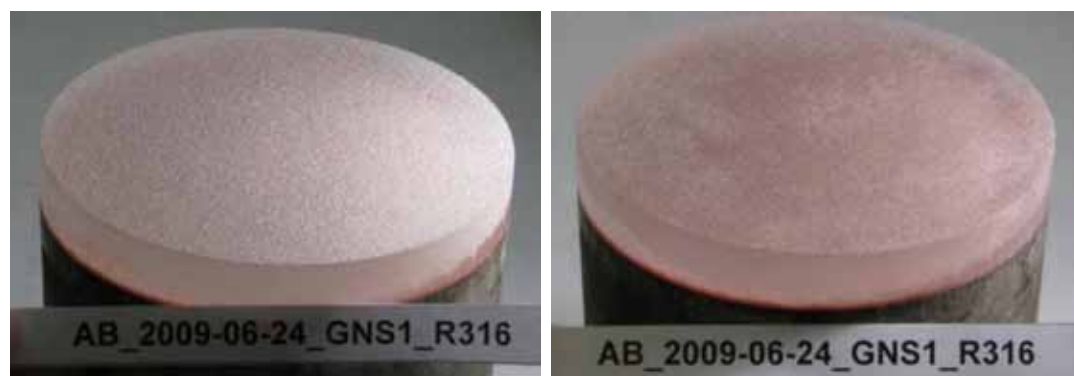
Abbildung 4.20: Glas-Probekörper mit der Rauheit GR3 vor und nach der Reinigung, bei der Glasstaub vom Sandstrahlen aus den Vertiefungen mittels Ultraschall entfernt wurde.
