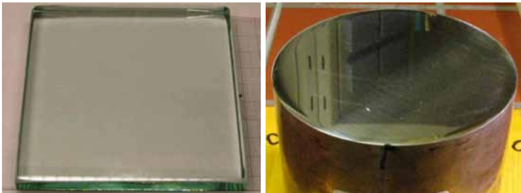
Abbildung 4.17: glatte Float-Glas- und glatt polierte Stahl- Oberfläche, Ø100 mm
