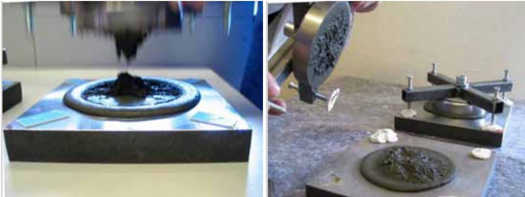
Abbildung 4.12: „Frischbetonhaftung“ demonstriert beim Abziehen des oberen Prüfstempels etwa 30 min nach dem Betonieren. Adhäsion > Kohäsion. 2 Versuche.
