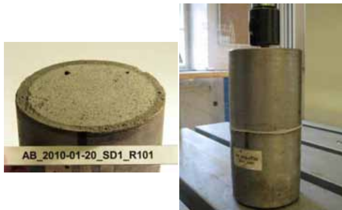
Abbildung 5.11: Probekörper für die Serie SD1-D: a) vor und b) nach der Klebung.
