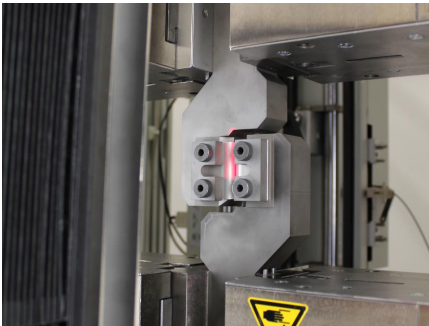
Abbildung 61 Durchführung der Scherzugprüfung
